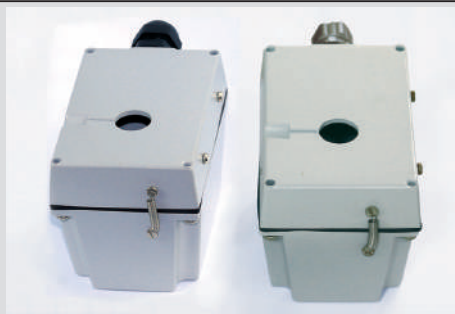
Después de 500 horas (junto a un producto no sometido a UV)
