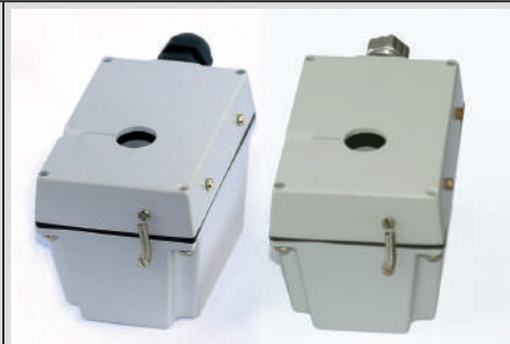
Después de 1000 horas (junto a un producto no sometido a UV)
