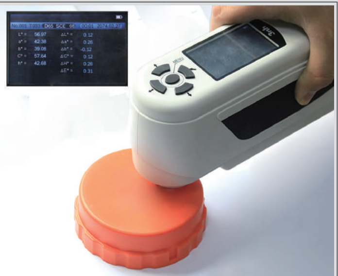
Medición de \Delta E en una cubierta de la carcasa
