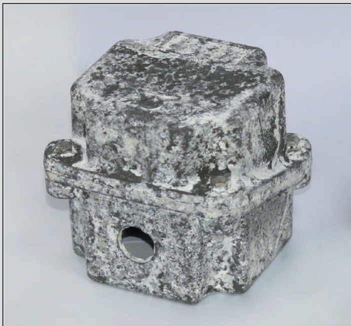
Superficie después del lavado con agua y jabón
